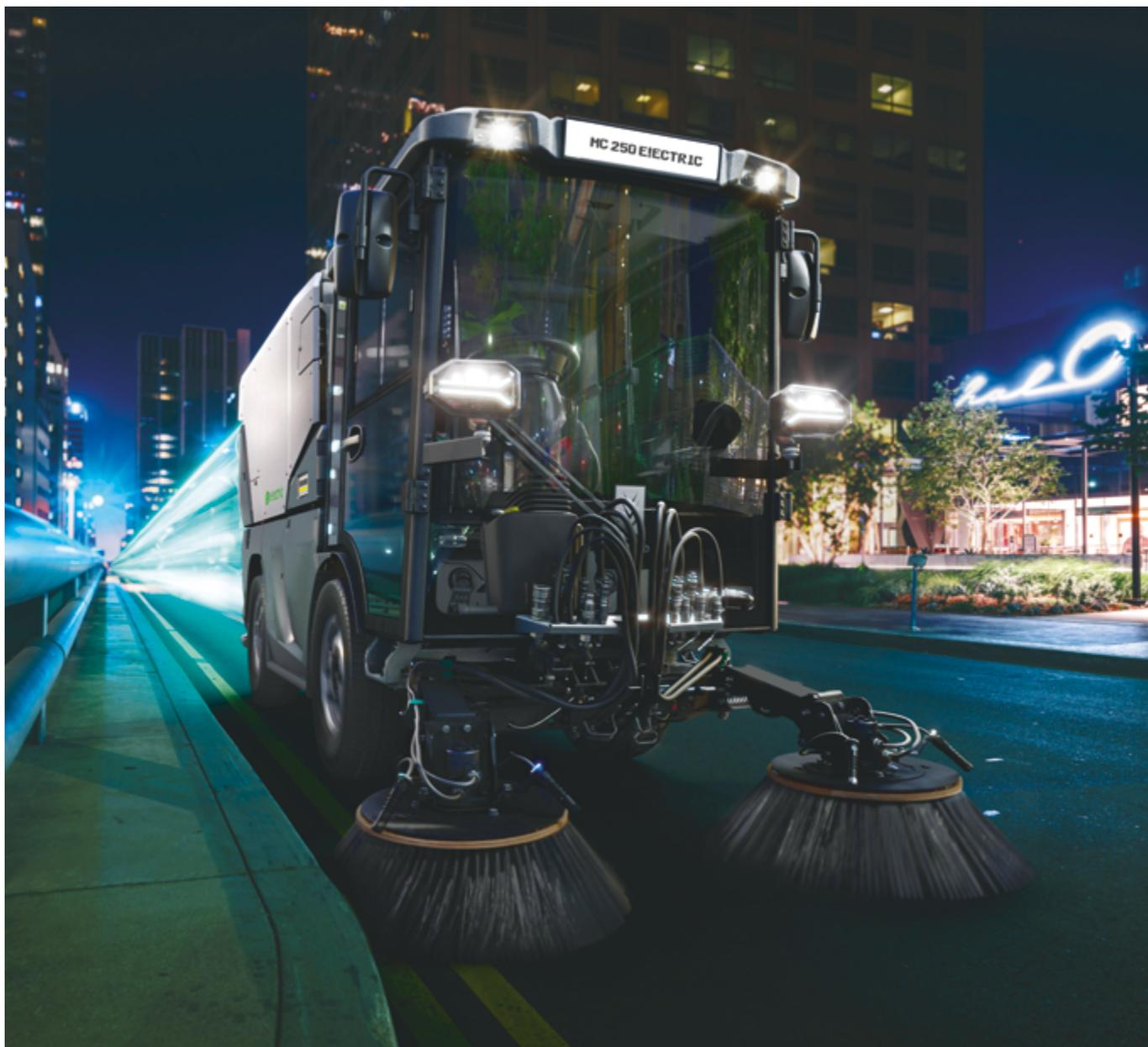
Längere Einsätze lassen sich dank hoher Batteriekapazität und einem Kehrgutbehälter mit 2,5 m<sup>3</sup> Volumen gut bewältigen.
