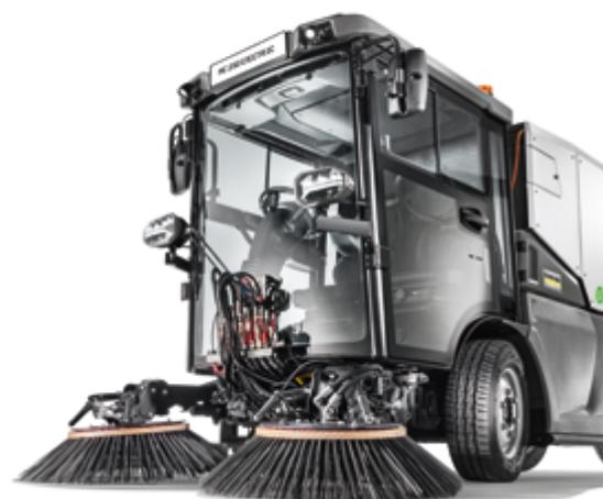
Die neue Elektro-Kehrmaschine MC 250 electric von Kärcher schafft mit einer Ladung eine Arbeitsschicht und verfügt über ein Wasserrecyclingsystem.
