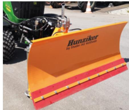
HUNZIKER – Schneepflug Typ 1T-150 an einem kommunalen Kompaktgeräteträger bzw. Kompakttraktor
